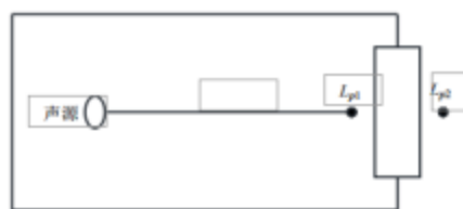
图 4-1 室内声源等效为室外声源图例
