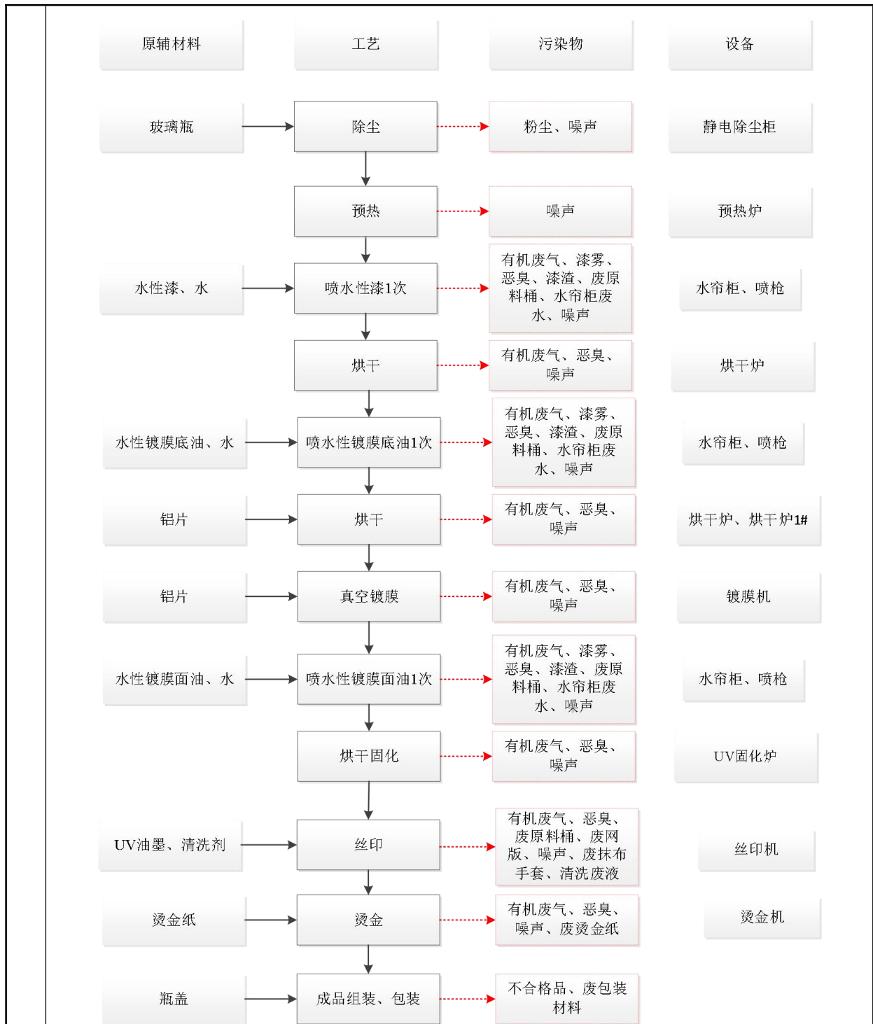
图 2-3 亮光款玻璃瓶生产工艺流程（UV 自动喷涂线）
