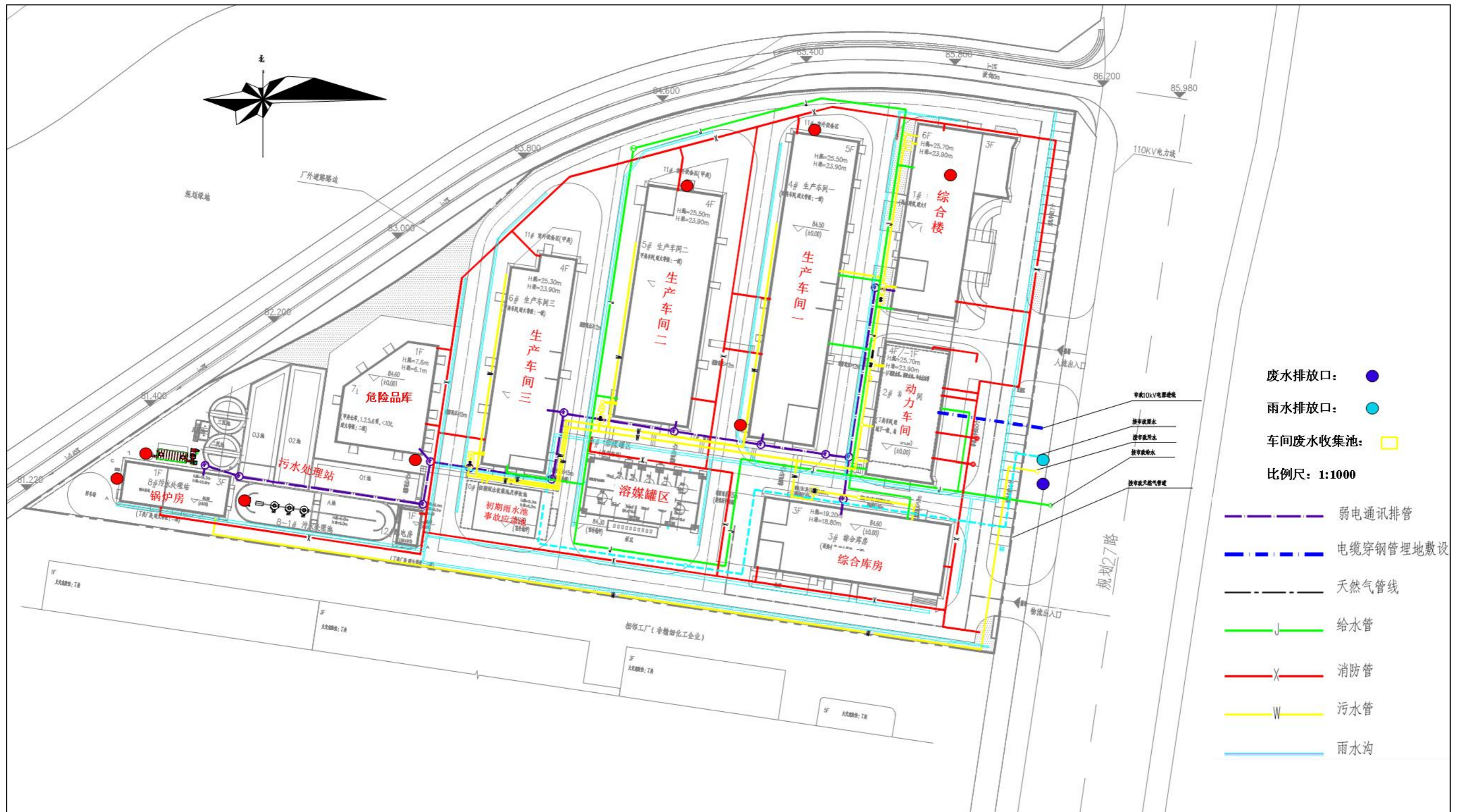
厂区雨污管网图
